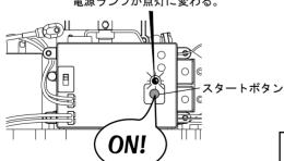
▶送信機のスロットルスティックが完全に下がっていない場合、安全機構が解除されないために電源ランプが点灯に変わりません。この場合はスロットルスティックを下げ、もう一度スタートボタンを押すと点灯に変わります。
