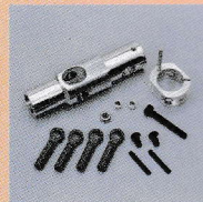
◆No. 60200 ¥3,900 3Dセンターハブ 位置調整機構を取り除いた、センサー固定部にベアリングを使用したセンターハブです。ピッチ設定、ヨーコントロールの舵角を増やすことができ、3Dフライトを行うための設定が無理なく行えます。
