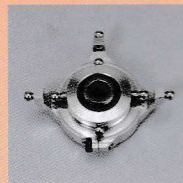
◆No. 60203 ¥17,800 HGスワッシュプレート(スベリオ用) フルメタルの強化型スワッシュプレートです。スベリオのベアリングを使用。高回転でも負荷がかかります。また、アップ、ローア間のクリアランスを微妙に調整できる為、長期間の使用で荷重が変化しても調整することが可能です。
