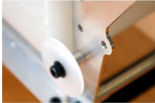
燃料タンクをフレームに差し込みます。後方からヘリをみて、左側に短い方のタンクホルダーで燃料タンクと止めます。ネジはM3 - 18とナイロンナットを使用し、プレート外側にM3プレートワッシャーを介します。同じように右側では長い方を使用し、M3 - 8CAP2本で固定します。
