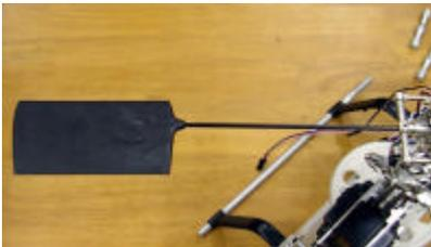
スタビライザーブレードを左右からねじ込みます。約25mm程度ねじ込むことができますので、あらかじめメスの先端から25mmの位置に印を付けておくと良いでしょう。ヒラーコントロールアームとブレードは水平になるように調整します。
