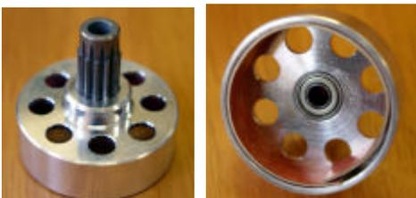
クラッチベルにピニオンギヤを取り付けます。確実に固定してください。クラッチベル内面にライニングを貼り付けます。エポキシ系接着剤で固定します。あらかじめ多少長くなっておりますので、少しずつ切り確認して取り付けます。
