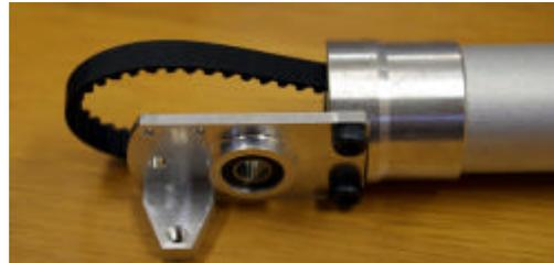
テールパイプに、テールベルトを通します。ギヤハウジングにプレートを1枚M3 - 5CAPにて取り付け、写真右の位置にレバーマウントをM2 - 6精密小ネジで取り付けます。下記写真のように、テールアウトプットシャフトをプレートのベアリング部に通し、テールプーリーカラー、テールプーリーの順にギヤケース内側より挿入し、プーリーをM3 - 4SETにてシャフトに固定します。シャフトはSETネジ固定用の溝がありますが、溝から先端までの距離の長い側がプーリー固定用のものです。プーリーの取り付け後、反対側のプレートをM3 - 5CAPで取り付け、後部にテールギヤクロスメンバーをM3 - 6CAPで取り付けます。
