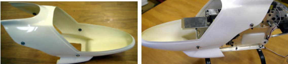
マウント位置にあわせ、ボディにラバーグロメットが差し込める穴を空けます。位置に十分ご注意ください。ラバーグロメットを瞬間接着剤等でボディに接着します。
