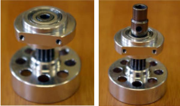
ギヤにスパーBRGハウジングを取り付けます。この際ネジロックでベアリングとギヤを接着すると耐久性があがります。ベル下部よりスタートシャフトを通して、上側にてスタートコーンで固定します。M4 - 4SETは、確実にスタートシャフトのDカット部に当たるよう確認してください。
