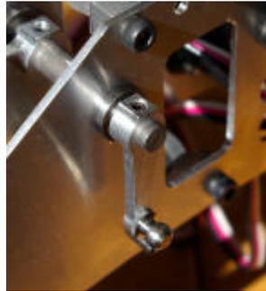
また、エレベータコントロールシャフトに、エレベータコントロールアームO U TをM3 - 3 S E Tで固定し、ピボットL 4をねじ込みます。
