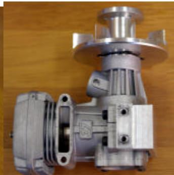
エンジンに、エンジンマウントをM3 - 10CAPで取り付けます。また、ファンベースにメタルファンをM3 - 6皿ネジで取り付けます。ファンをエンジンにねじ込みエンジン付属のナットで完全に締め付けて固定します。この際、エンジンに付属のワッシャーやドライブワッシャー等はすべて取り外してください。
