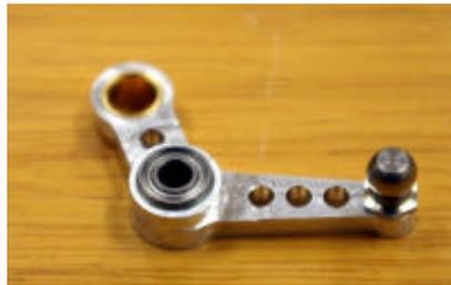
テールPCプレートにボールリンクおよびピボットL4を取り付けます。レバーにもピボットL6をつけます。
