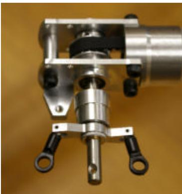
テールPCプレートをアウトプットシャフトに通し、テールPCレバーをM3 - 10CAPでM3切削ワッシャーを介してレバーマウントに取り付けます。この際レバーのカップにPCプレートのピボットL4を挿入します。
