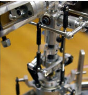
ウォッシュアウト先端部のピボットと、ヘッド部ヒラーコントロールアームのボール部を連結します。
