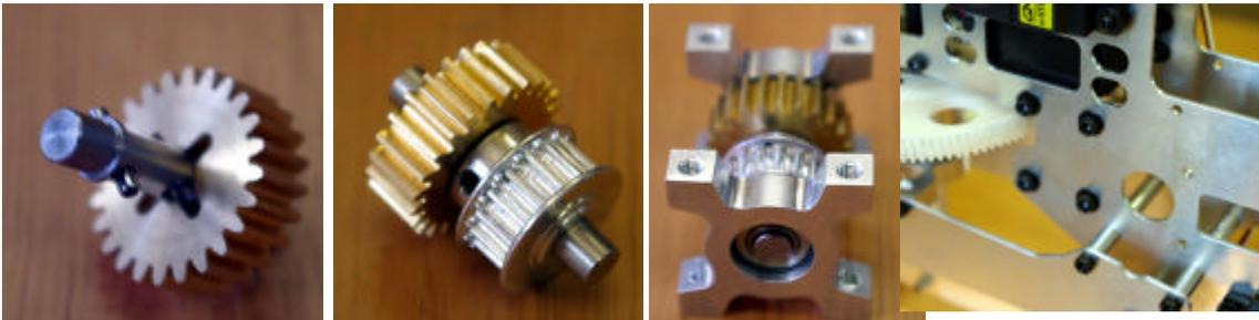
カウンターギヤシャフトにストップピンを通し、カウンターギヤを差し込みます。上から写真中のようにカウンターギヤプーリーを差し込み、M3 - 4SET1本で、シャフトの穴位置にあわせ固定します。それぞれベアリングが内側になるようにカウンターギヤBRGハウジングを挿入し、左写真のフレーム位置に固定します。向きはカウンターギヤが上側になり、プーリーが下側です。後ほどテールベルトをプーリーに通しますので、ここでは仮組にしておきます。
