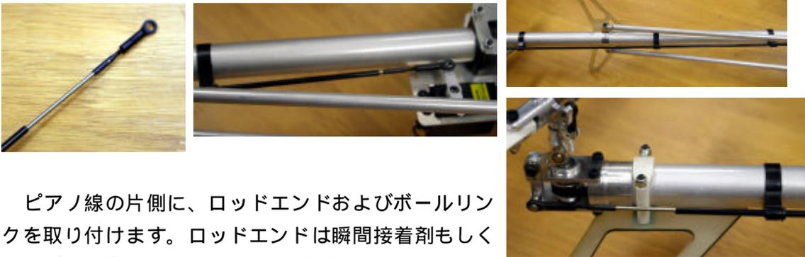
ピアノ線の片側に、ロッドエンドおよびボールリンクを取り付けます。ロッドエンドは瞬間接着剤もしくはエポキシ系接着剤で確実に接着します。
