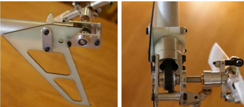
垂直尾翼を取り付けます。写真の位置にホルダーをテールパイプにクランプする形で、M3 - 3 0 C A Pとナイロンナットで固定します。尾翼側には保護のためのプレートを介してください。
