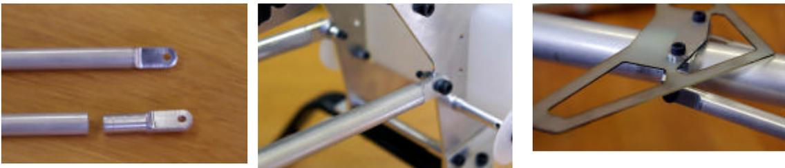
テールサポーター両端に、エンドをエポキシ系接着剤で接着します。フレームと水平尾翼マウントに、これを取り付け連結します。フレーム側はM3 - 12CAPとナイロンナットで、水平尾翼マウント側はM3 - 10CAPで取り付けます。水平尾翼の水平を出し、固定してください。あまり強く締めすぎないように注意してください。
