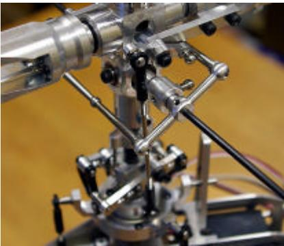
スワッシュプレートアッパー部と、ヘッドピッチアームに取り付けたミキシングアーム中心より短い側を連結します。
