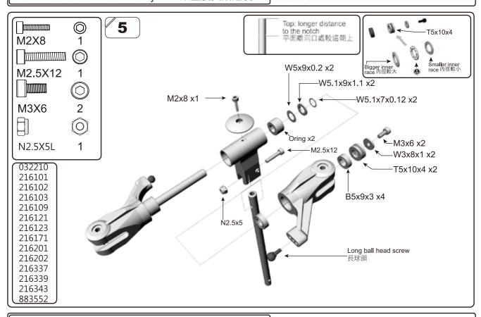
2 Blades Rotor Head Assembly2 2 學主旋翼頭組裝2
