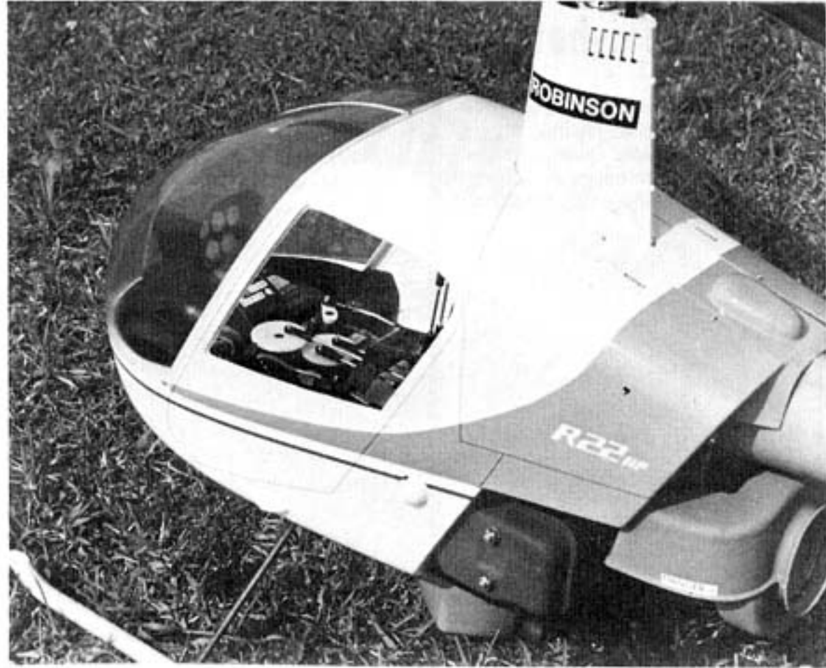
Radioinstallationen. Det patenterade MCS-systemet är monterat ovanför tanken.
