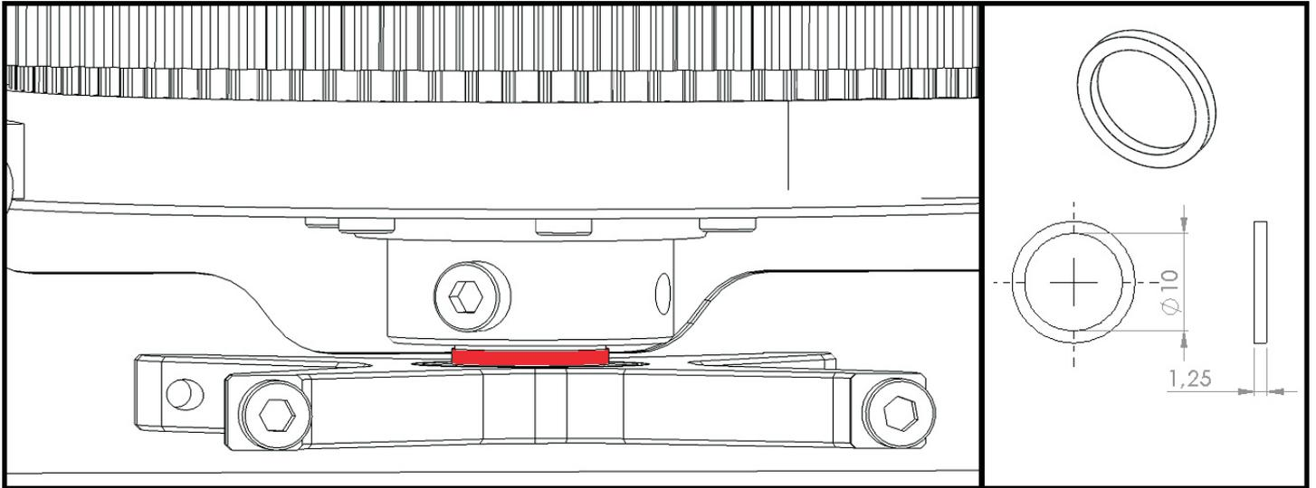
Bitte montieren Sie den 1.25mm starken Distanzring zwischen das untere Domkugellager und der Freilaufhülse.
